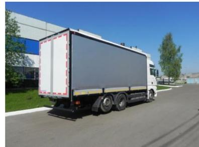
Алюминиевая бортовая платформа, стальной передний портал, сдвижные средние стойки, задние распашные ворота, тент, настил пола – ламинированная влагостойкая фанера с противоскользящим покрытием толщиной 27мм, утепленные кольца для фиксации груза, «Шторный» механизм Versus (Бельгия), позволяющий производить независимую загрузку как через бока, так и крышу.
