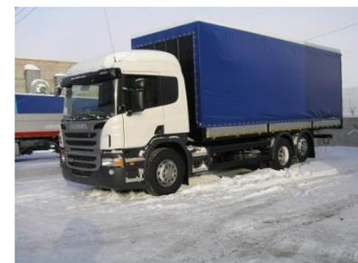
Алюминиевая бортовая платформа, стальной передний портал, быстросъемные средние стойки, задние распашные ворота, тент, настил пола – ламинированная влагостойкая фанера с противоскользящим покрытием толщиной 27мм,
